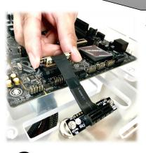
将此延长线的金手指垂直插入槽口, 注意不要插反。
