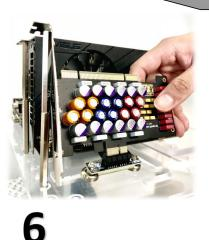
〉将声卡正常插入 PCI-E 槽口。
